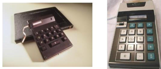
**1972** TI entra nel mercato con il modello TI-2500 Datamath, al costo di soli \$ 150. La calcolatrice utilizza per la prima volta un singolo chip per eseguire tutte le funzioni matematiche. Il dispositivo è l'antenato dei moderni microprocessori, la cui invenzione è attribuita sia alla TI che a Intel.
